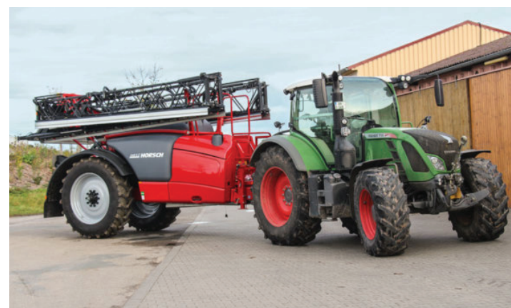
Nur gemeinsam erschwinglich: Die neue HighTech-Pflanzenschutzspritze der Agrotechnic Strüth mit GPS-gesteuerter Teilbreitenschaltung und unterschiedlichen Düsenprofilen.
