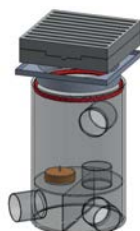
Trennschacht DA 00 mit seitlichem Zulauf, Adapter und Gussaufsatz 50x50 Kl. D400
